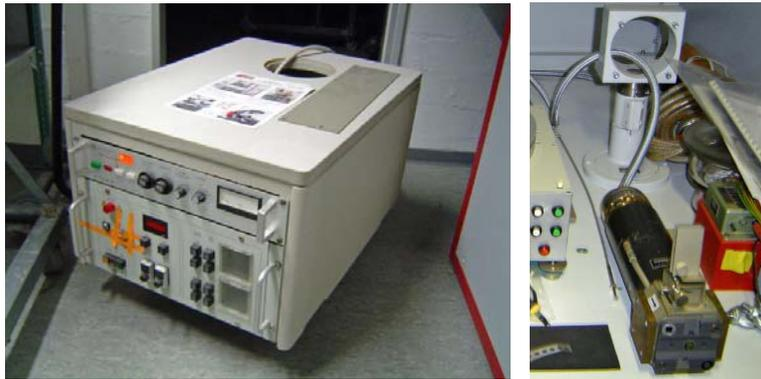
Vorhandener Generator Siemens KRISTALLOFLEX 710 (links) und Cu-Röntgenröhre (rechts), die zu einem Laue-Diffraktometer aufgerüstet werden sollen. Ohne Detektor sind die Geräte nicht nutzbar.
